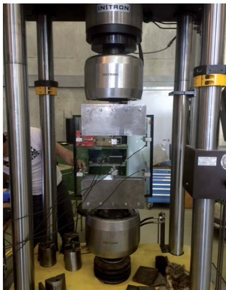
Essais de traction à l'EPFL sur les assemblages collés verre-verre
